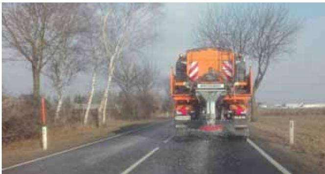
Im NÖ Straßendienst wird seit Jahrzehnten grundsätzlich Feuchtsalzstreuung durchgeführt. Der besondere Vorteil bei dieser Streutechnik liegt darin, dass einerseits eine bessere Haftung und gleichmäßigere Verteilung der Streumittel auf der Fahrbahn erreicht wird, und andererseits eine schnellere Tauwirkung einsetzt.
